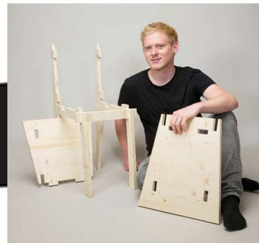
Paul Leifer hat sich bei seinem »Steckstuhl« an ein Zitat von Max Frisch gehalten: »Nur was geleimt ist, geht aus dem Leim.« Die Konstruktion verzichtet auf Verbindungshilfen wie Dübel, Schrauben oder Leim und setzt ausschließlich auf Steckverbindungen. Der Stuhl besteht aus fünf Teilen und kann im ursprünglichen Schnittmuster angeordnet flach transportiert werden.
